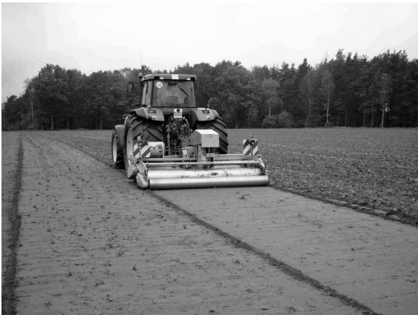
Abb. 1 Seit vielen Jahren Vergangenheit im deutschen Zuckerrübenanbau und heute entbehrlich: Spezialgerät zur Ausbringung von flüssigen Nematiziden zur Bodenentseuchung.
